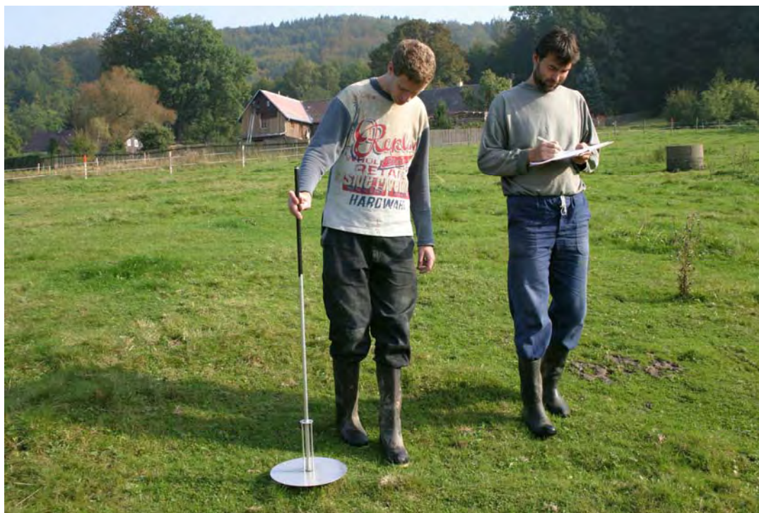
Obr.19 Kalibrovaná tyč s talířem o určité hmotnosti, tzv. talířové měřidlo: rising-plate-meter, standardní pomůcka pro měření výšky travních porostů.
