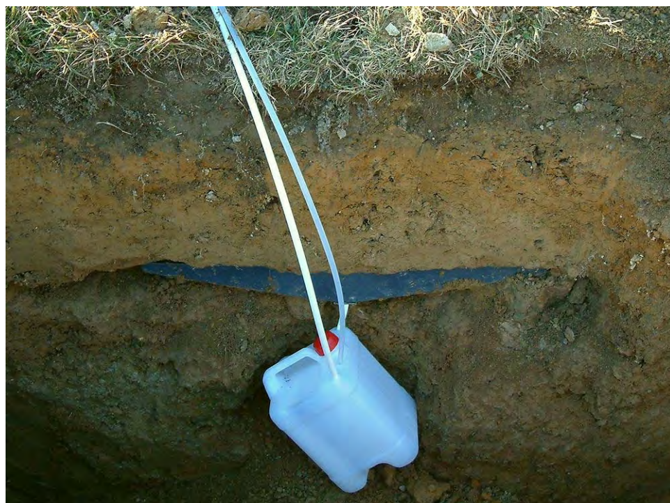
Obr.67 Půdní profil s lyzimetrickou sondou pro zjišťování koncentrace živin v podpovrchových průsakových vodách.
